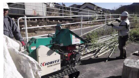
【チップパーによる破碎作業】
