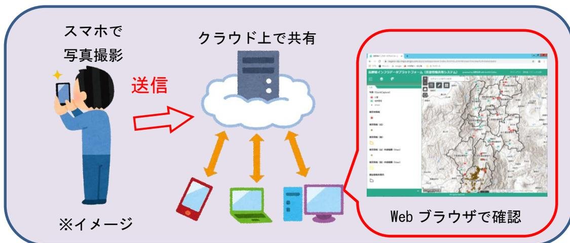
図 4-4 インフラデータプラットフォームの概念図
