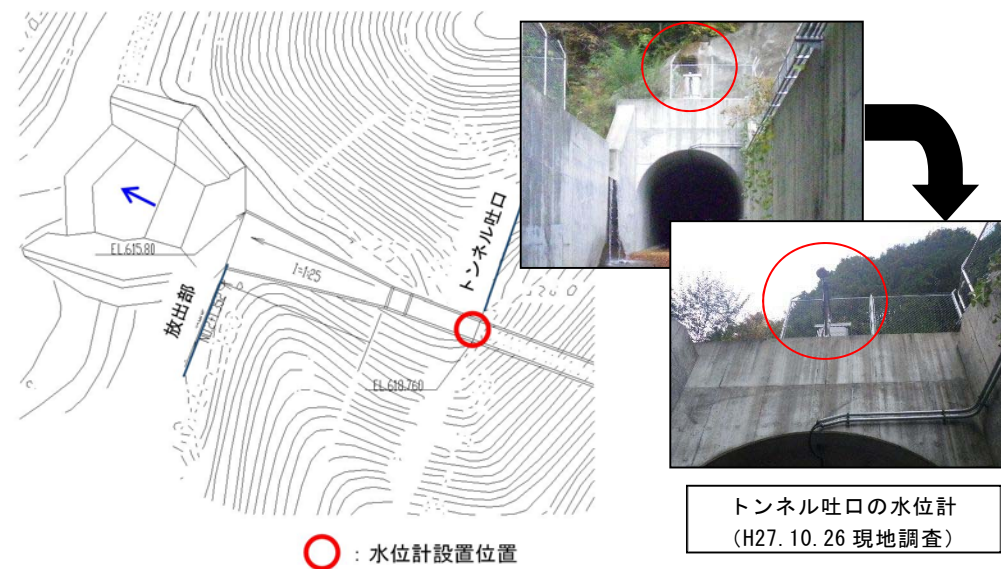
図-4.39 水位計の設置位置図（バイパストンネル吐口）
