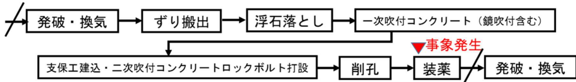
図4-1 掘削サイクル
