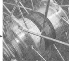
ライトの発電機
