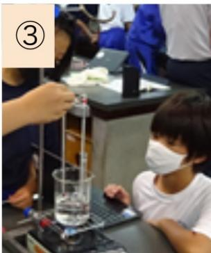
写真③④ 子供たちは、2本の温度計を用いて液体と水の温度を1分おきに同時に測定し、即座にグラフ化できる表計算ツールに各温度を入力した。75℃を過ぎると、「試験管内の液体だけ温度が上がらなくなった。沸騰も激しくなっている！」「80℃位で温度が変わらないので、やっぱり液体はエタノールだ。」と、画面のグラフと実際の反応の様子を見比べて考察していった。
