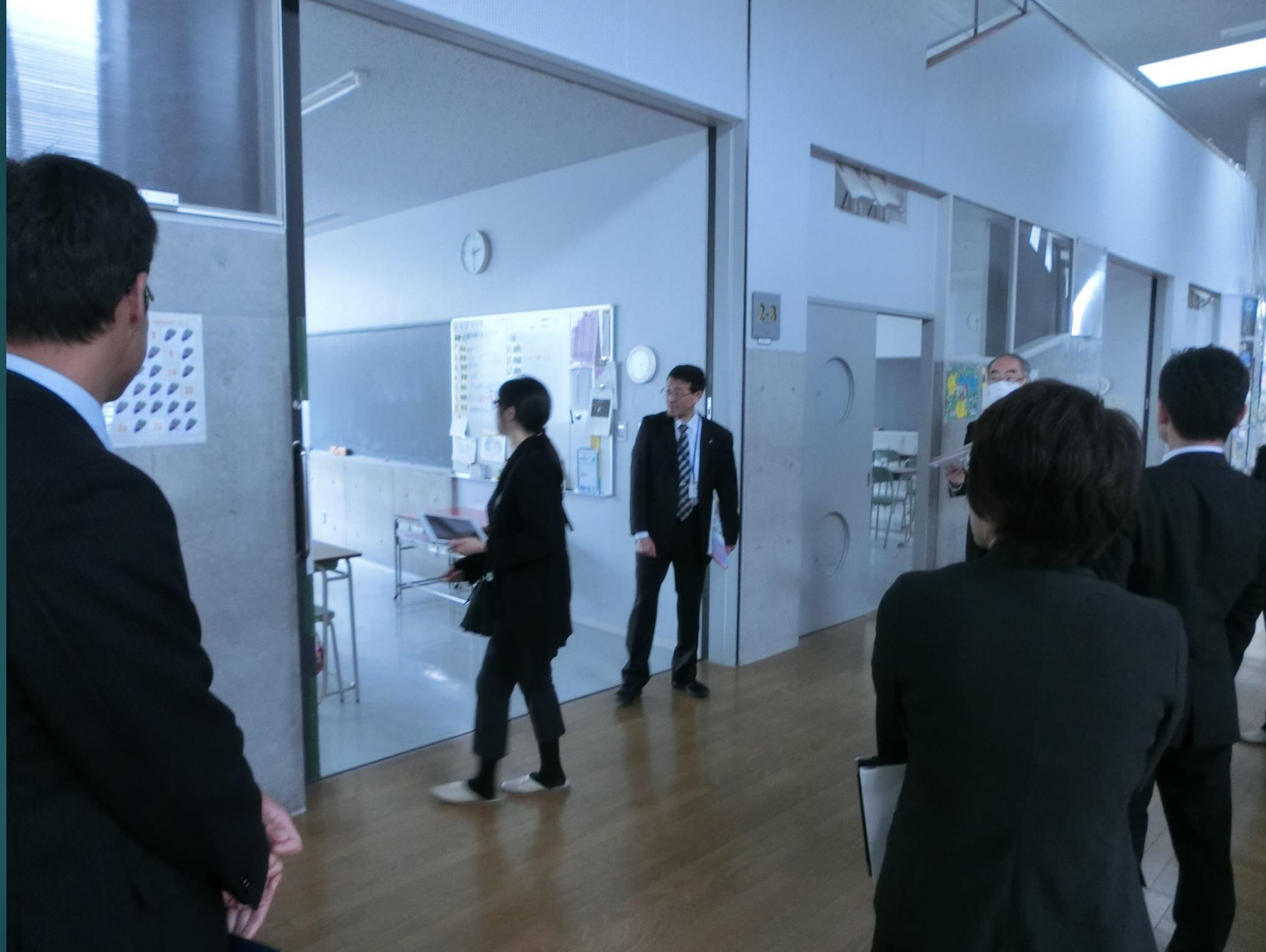
中学棟 1階 教室と廊下との関係 大きな開口部 廊下と一体に利用できる
