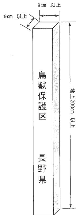
(備考) 支柱の太さの寸法は、木材を使用する場合のものであり、鉄材等を用いる場合にあつては、これと同程度以上の強度があれば、その寸法によらないことができる。
