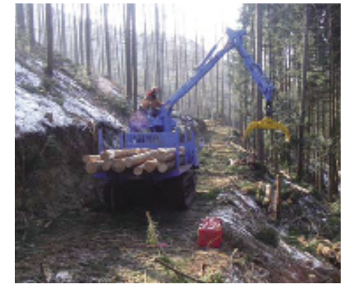
林内路網と高性能林業機械を使った間伐材の搬出
