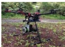
ドローンレーザー測量
