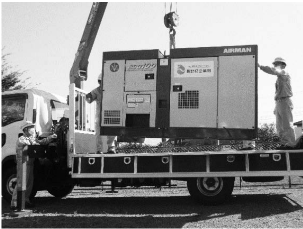
電源車（クレーン付トラック+可搬型発電機）
