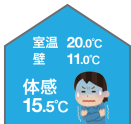
[図-7] 断熱性能による体感温度の比較 出典：「HEAT20 設計ガイドブック」 (2015年5月 設計ガイドブック作成WG) を基に作成
