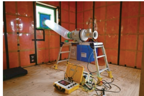
住宅の相当隙間面積を専用測定器によって計測している様子。(気密測定は工事完了時に加え、気密施工不良箇所の確認や計測後の手直しが可能なら、断熱・気密工事終了時の2回の実施が望ましい。)
