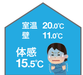
【図-7】断熱性能による体感温度の比較 出典：「HEAT20設計ガイドブック」 (2015年5月 設計ガイドブック作成WG)を基に作成
