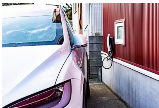
電気自動車と非常時電源を供給する家庭用充電設備 (V2H 機器)
