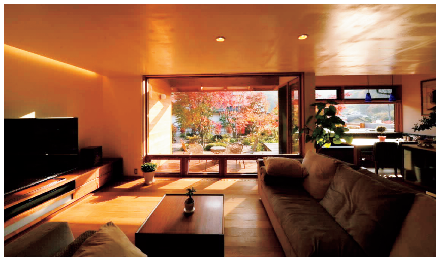
庭を切り取る上部窓と通風のための下部窓
