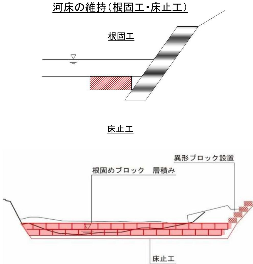
○出水時の局所洗掘や河床低下を防止するため、根固工や床止工を実施します。
