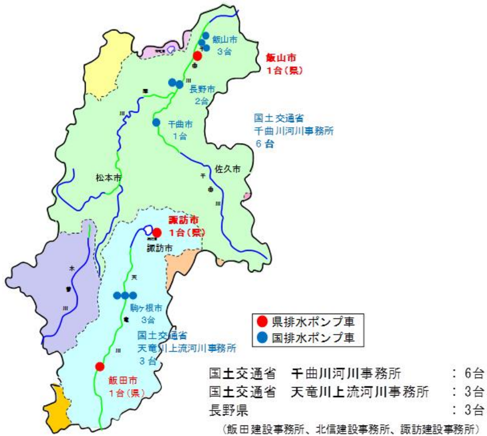
図 4.3.17 県内の排水ポンプ車の配置状況
