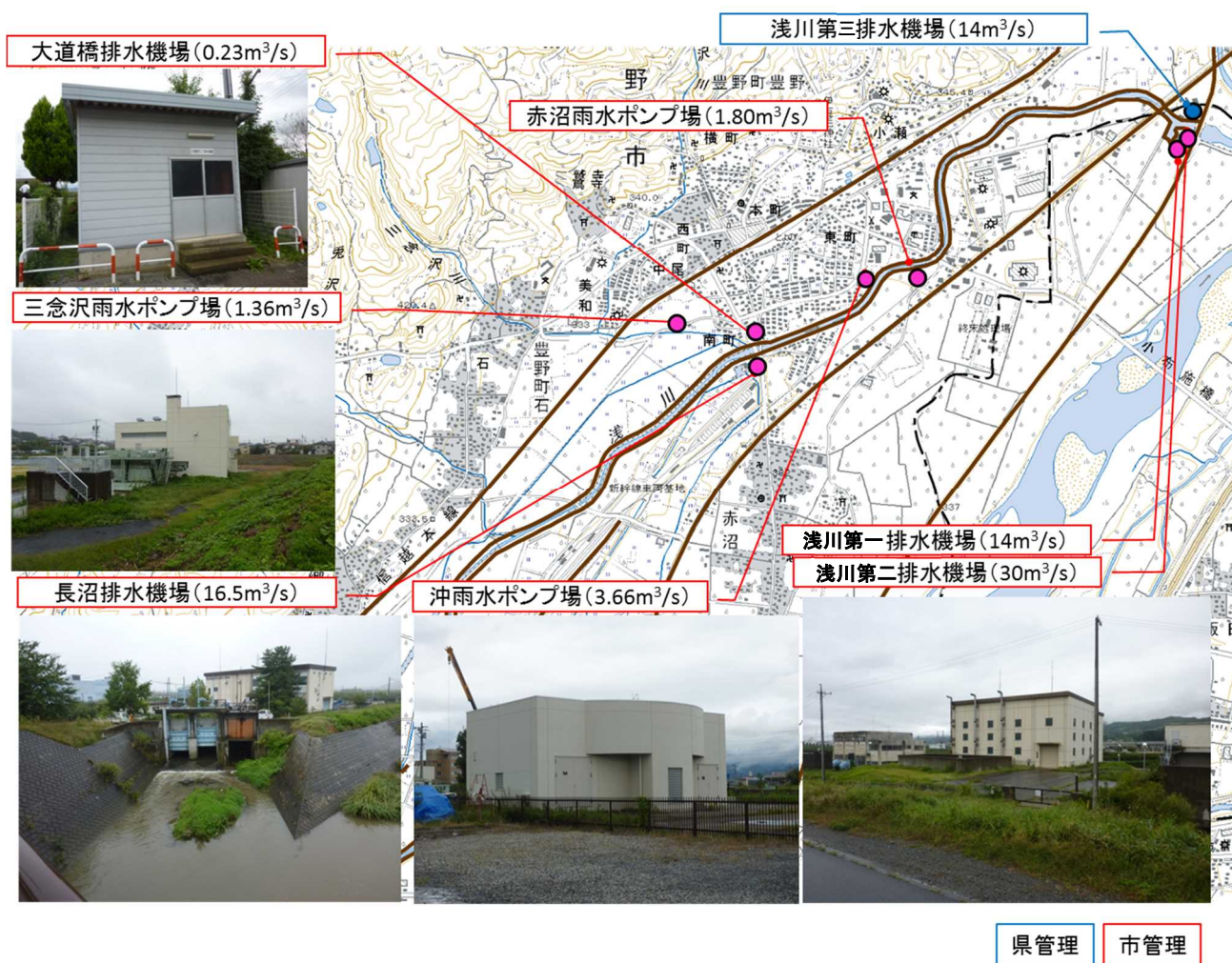
図 4.6.3 浅川下流部の排水機場・雨水ポンプ場設置状況
