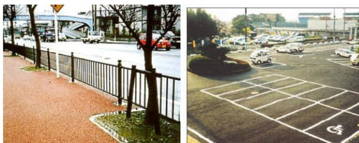
図 4.3.15 透水性舗装 施工例
