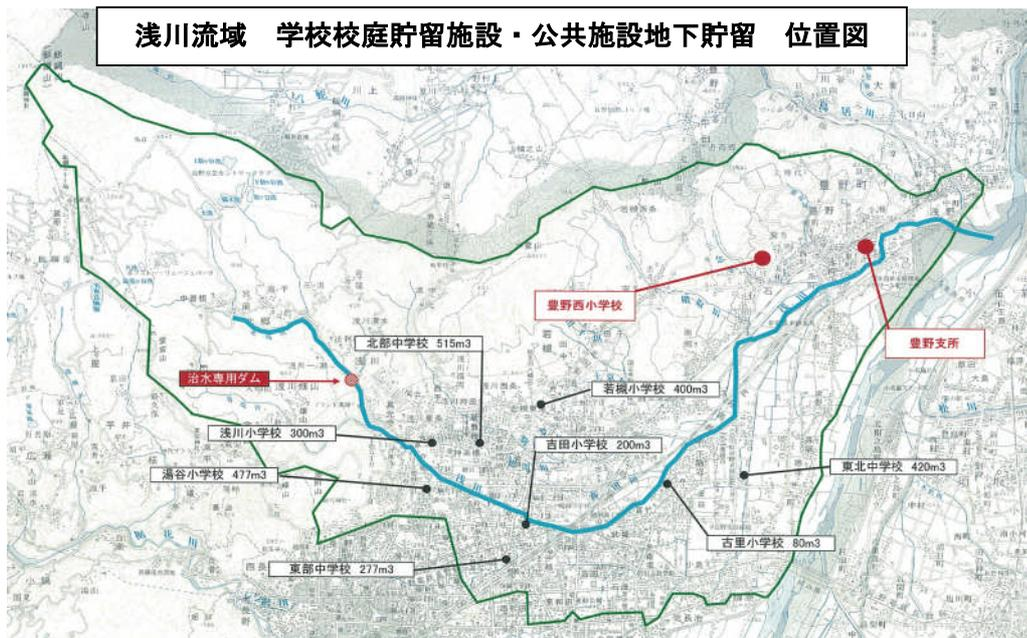
図 4.3.10 浅川流域の学校校庭貯留施設・公共施設地下貯留施設 位置図
