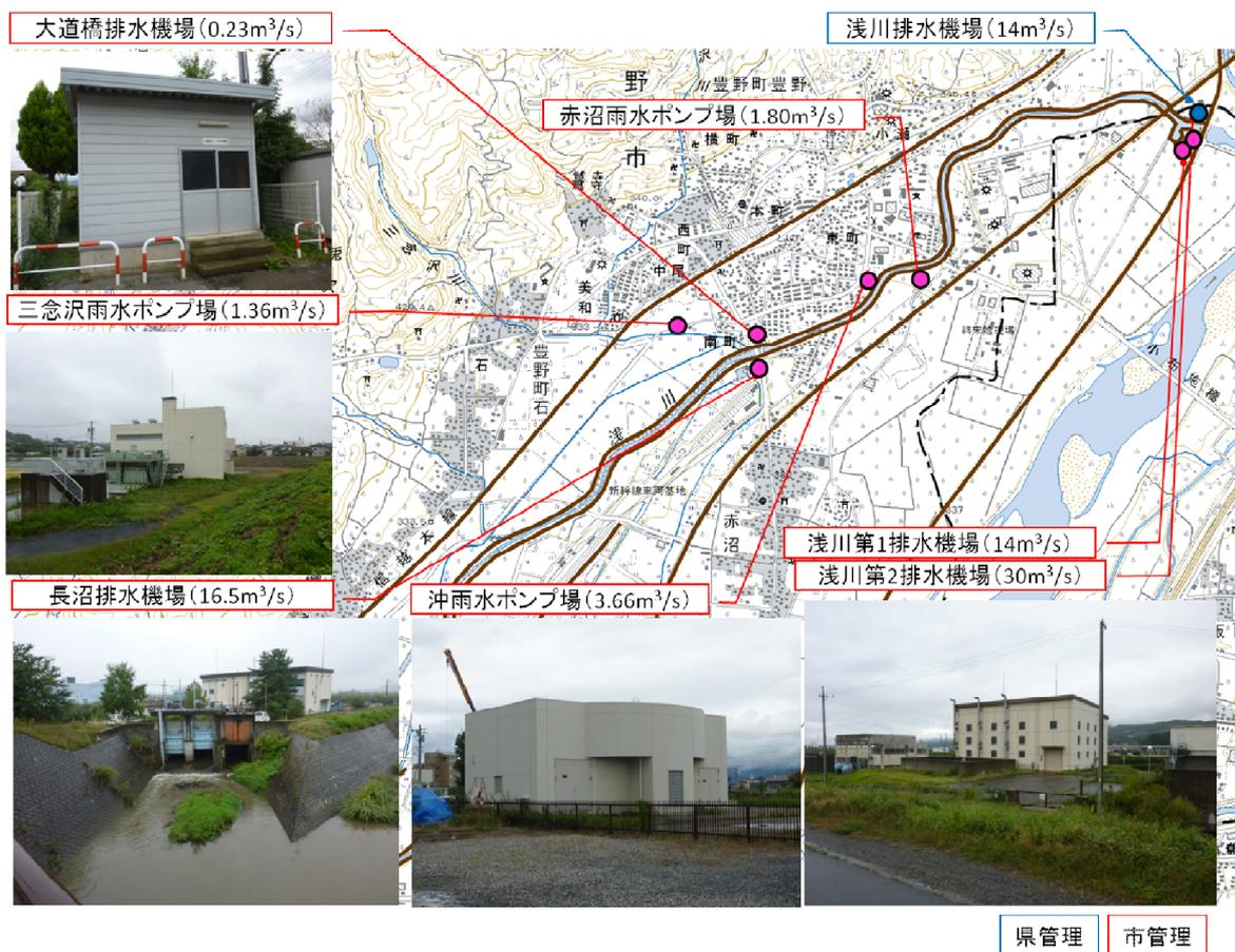
図 4.3.16 浅川下流部の排水機場・雨水ポンプ場設置状況
