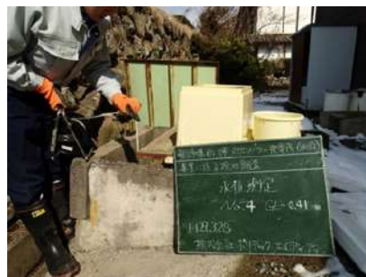
既存井戸の水位調査（水位）
