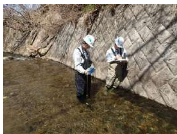
流速計による流量調査
