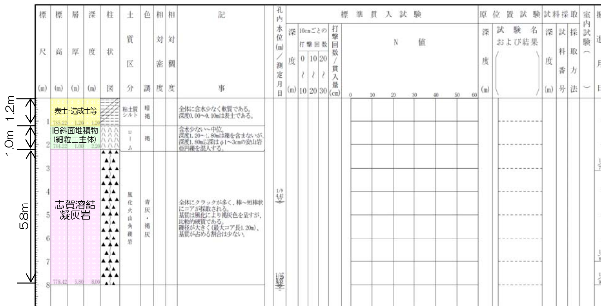
図5-10-10(8) ボーリング柱状図
