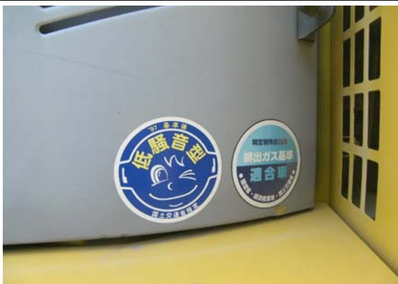
写真 4.1.5 低騒音型建設機械の使用
