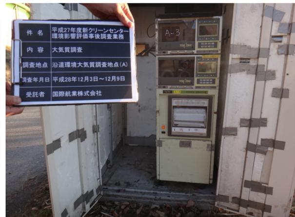
写真 4-1-6 NO<sub>2</sub>、SPM（測定中）
