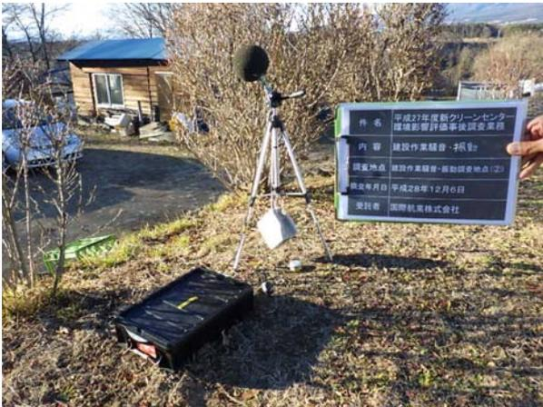
写真 4-2-3 建設作業騒音・振動レベル
