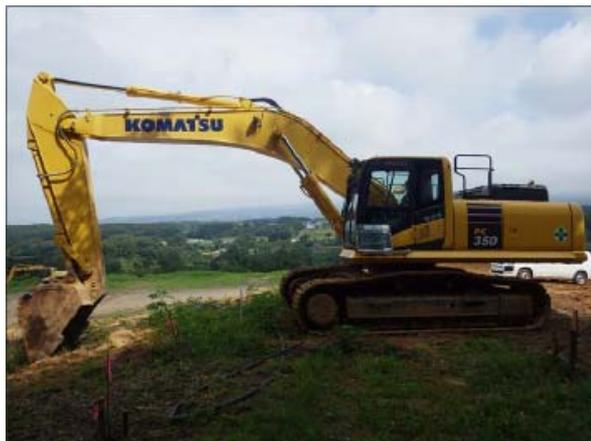
写真 4-1-10 排出ガス対策型建設機械の使用
