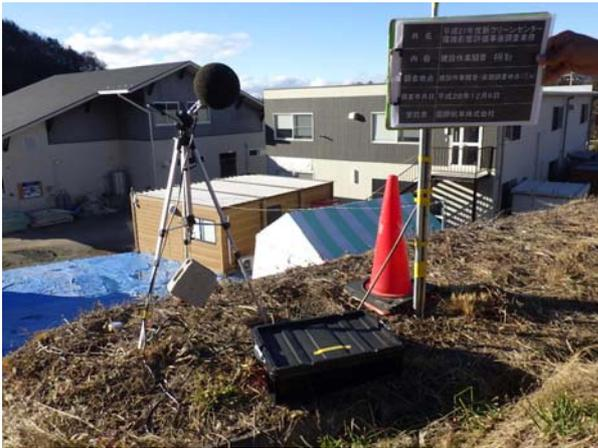
写真 4-2-1 建設作業騒音・振動レベル
