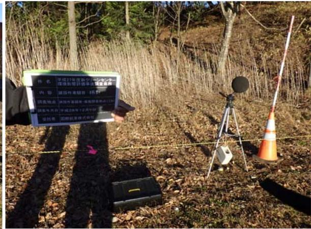
写真 4-2-2 建設作業騒音・振動レベル
