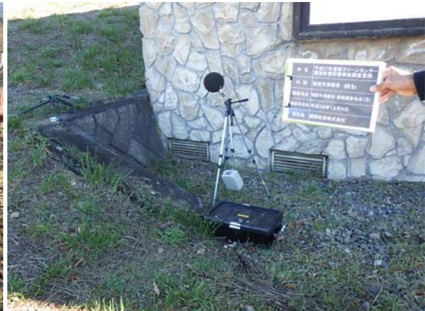
写真 4-2-4 建設作業騒音・振動レベル
