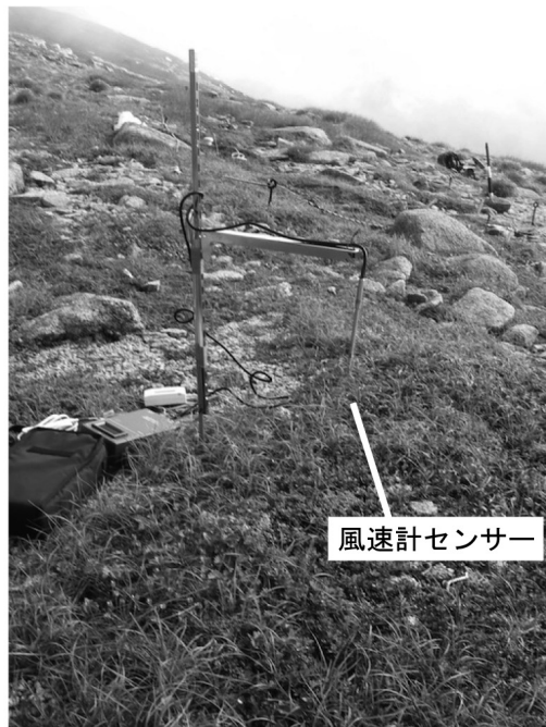
図 2 風速観測の様子 左が OTC, 右が CTRL.
