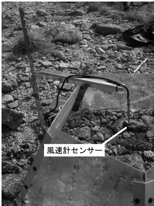
図 2 風速観測の様子 左が OTC, 右が CTRL.
