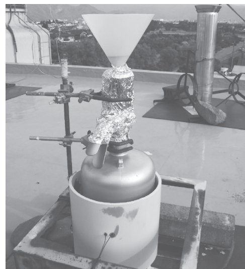
写真 ろ過式捕集法による降水の採取
