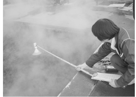
水上置換法でのガス採取
