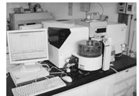
金属成分の分析に用いる原子吸光分析装置
