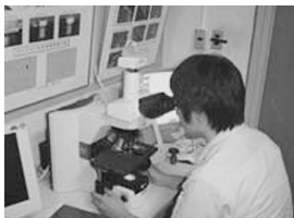
アスベストの検査作業
