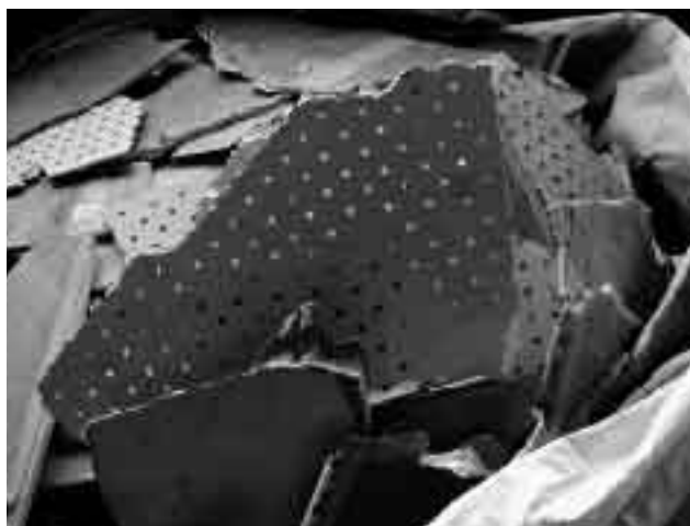
廃棄された石膏ボード
