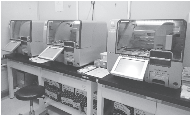
写真1 自動核酸抽出装置
