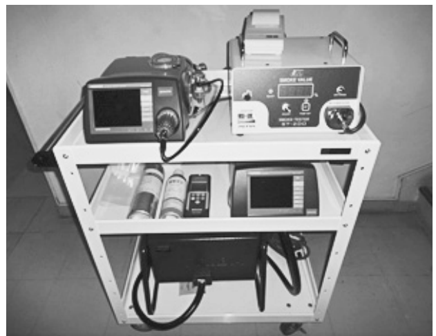
写真2 排出ガス測定器 上段 CO/HCテスター（左）黒煙測定器（右） 中段 オパシメータ（本体、検出部は下段）
