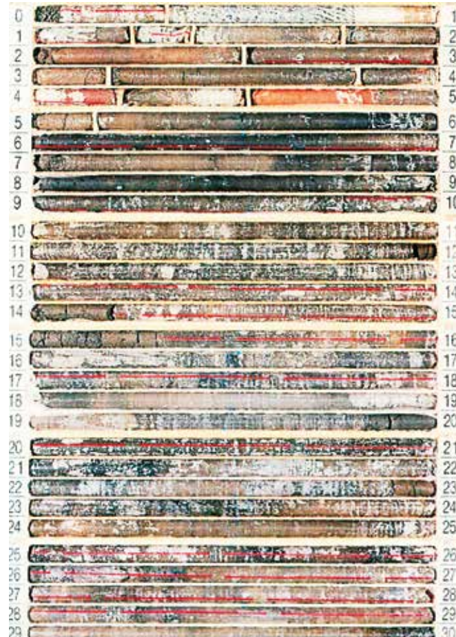
写真1. 諏訪湖南岸で掘削されたボーリングコア(掘削深度30.0m)。コアパック(ビニール袋)に包まれた状態の写真。数字は深度(m)を示す。
