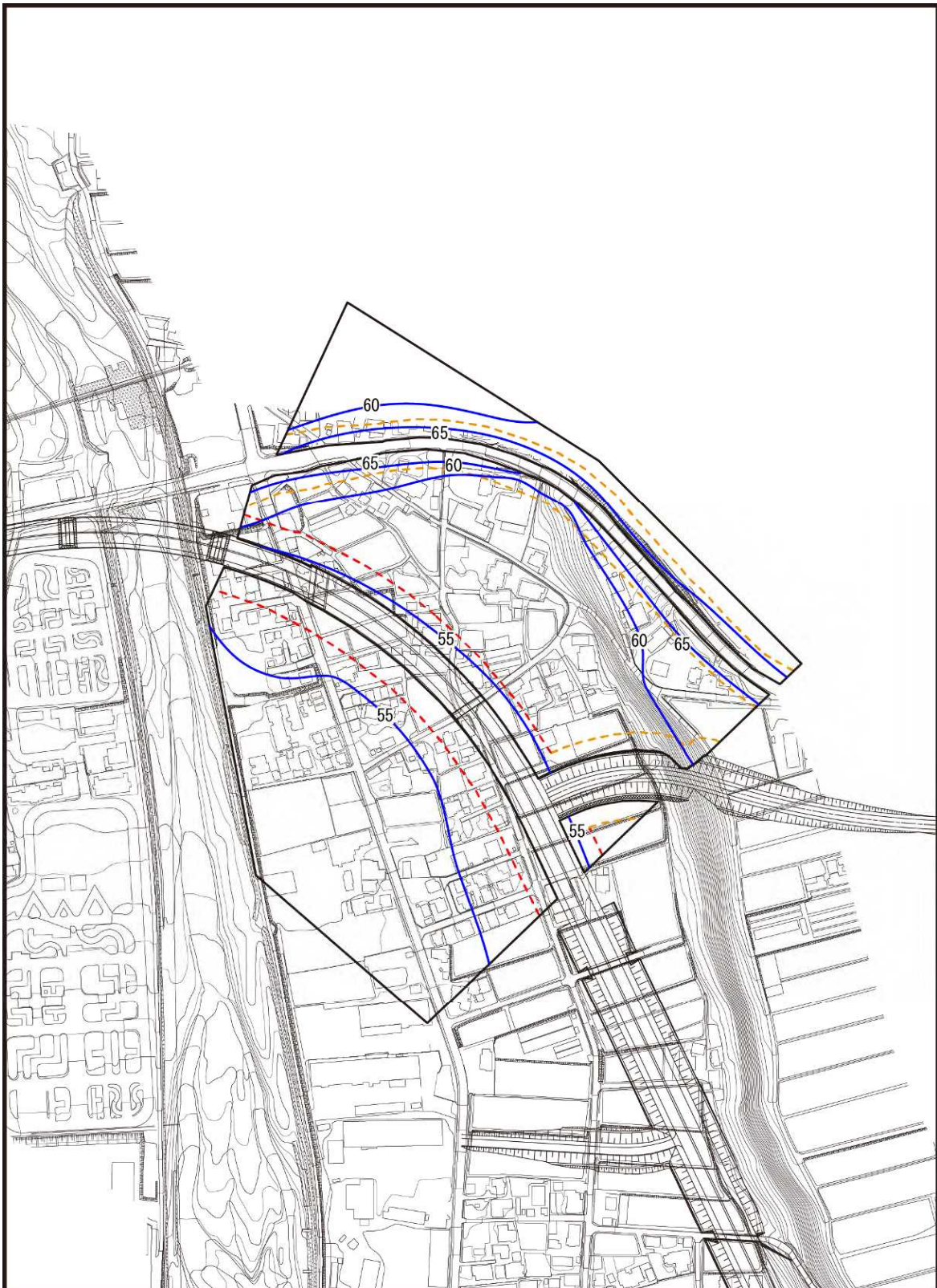
図 3.1-1(14) 自動車の走行に係る騒音分布図(2. 宮田村大田切)2 階昼間
