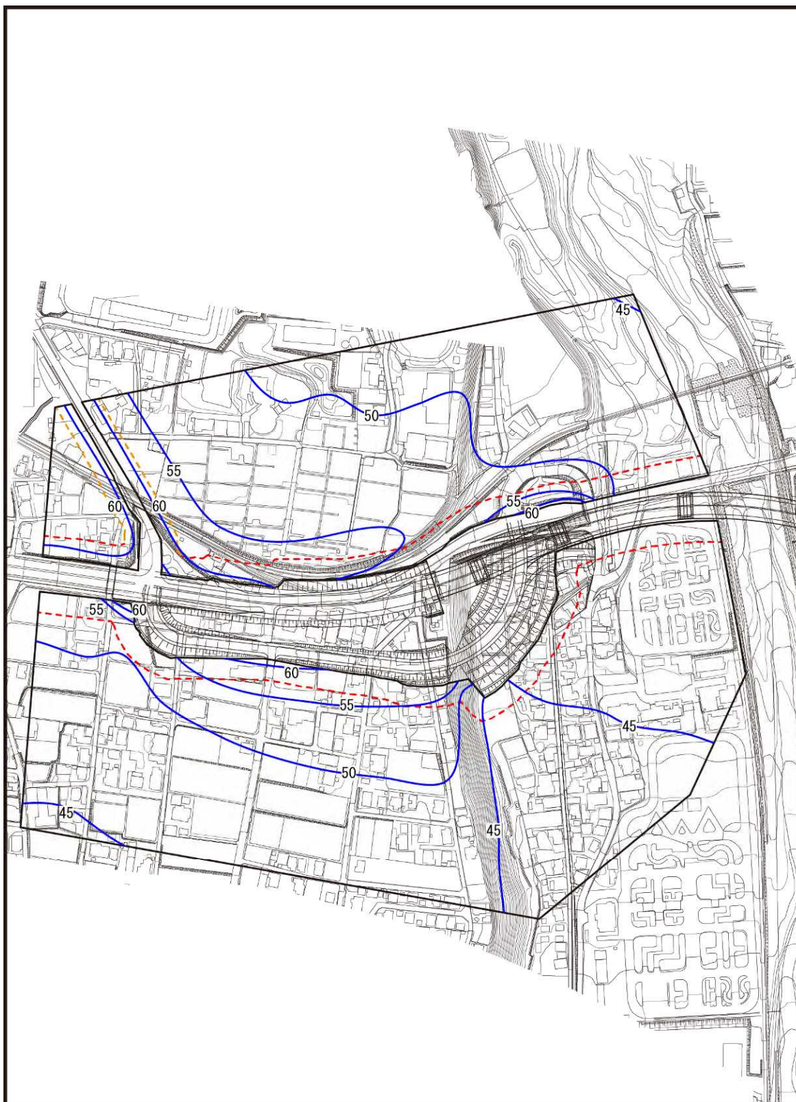
図 3.1-1 (19) 自動車の走行に係る騒音分布図(1. 駒ヶ根市赤穂(大田切))2 階夜間
