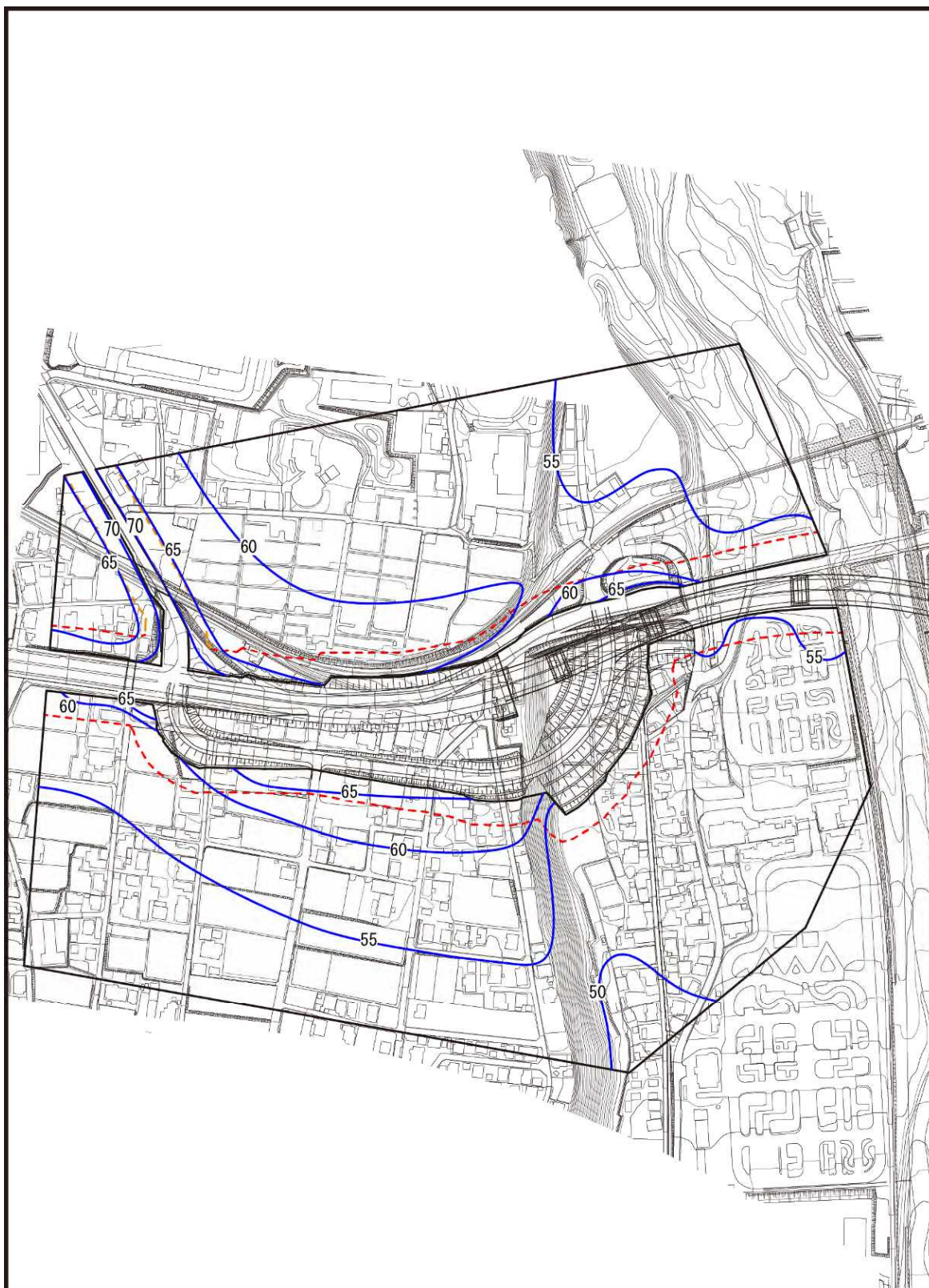
図 3.1-1(13) 自動車の走行に係る騒音分布図(1. 駒ヶ根市赤穂(大田切))2 階昼間
