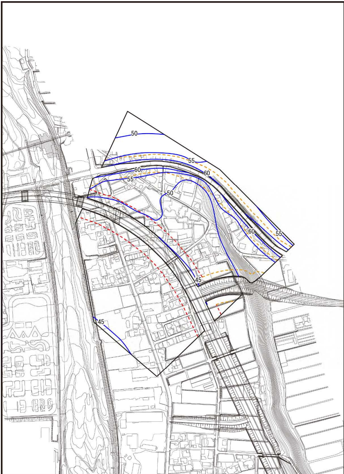
図 3.1-1 (20) 自動車の走行に係る騒音分布図(2. 宮田村大田切)2 階夜間
