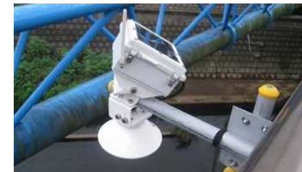
洪水に特化した低コストな水位計の設置例
