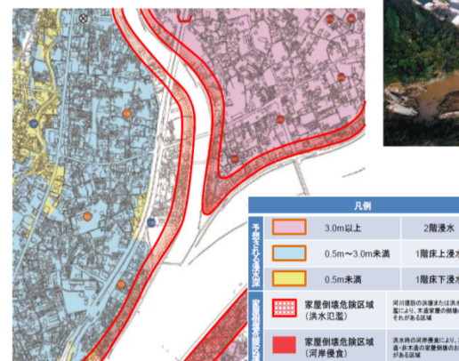
家屋倒壊危険ゾーンの表示例
