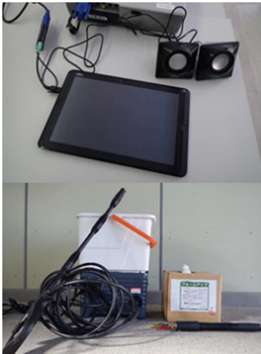
図1 整備した物品類 上：タブレット用のプロジェクターケーブルと外付けスピーカー 下：タンクカートリッジ式噴霧器、発泡ノズルおよび発泡補助剤
