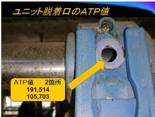
図-7 ユニット脱着口の汚れ
