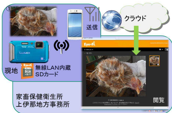
図2 デジタルカメラ～PCへの画像送信方法
