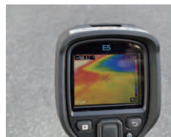
▲アスファルト舗装 50.1℃
