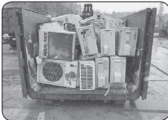
土砂が流入したエアコン室外機
