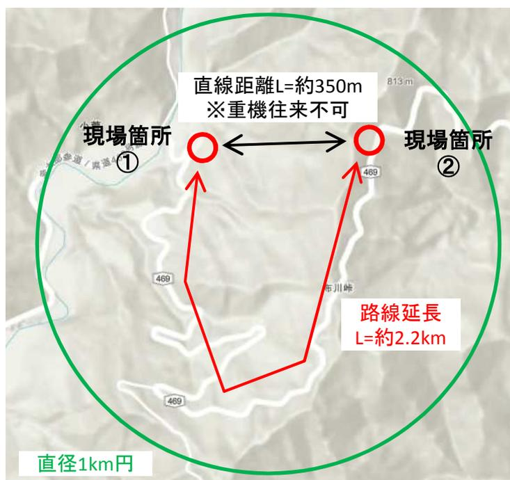
直径 1 km 以内の同一施工箇所とみなす (例)
