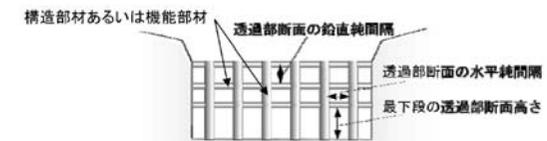
図 9-4-36 透過部断面の純間隔
