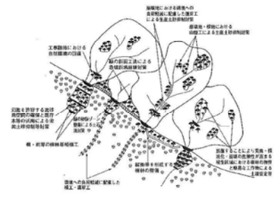
図4.3.2(b) 都市山麓グリーンベルト整備による砂防事業対策イメージ
