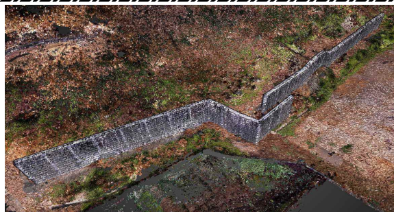
地上レーザースキャナーより取得した点群データによる3D画像
