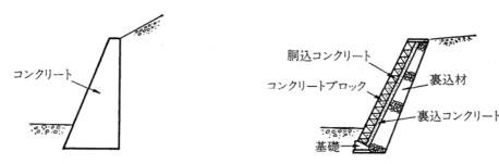
(a) 自立式護岸の例(コンクリート擁壁工)
