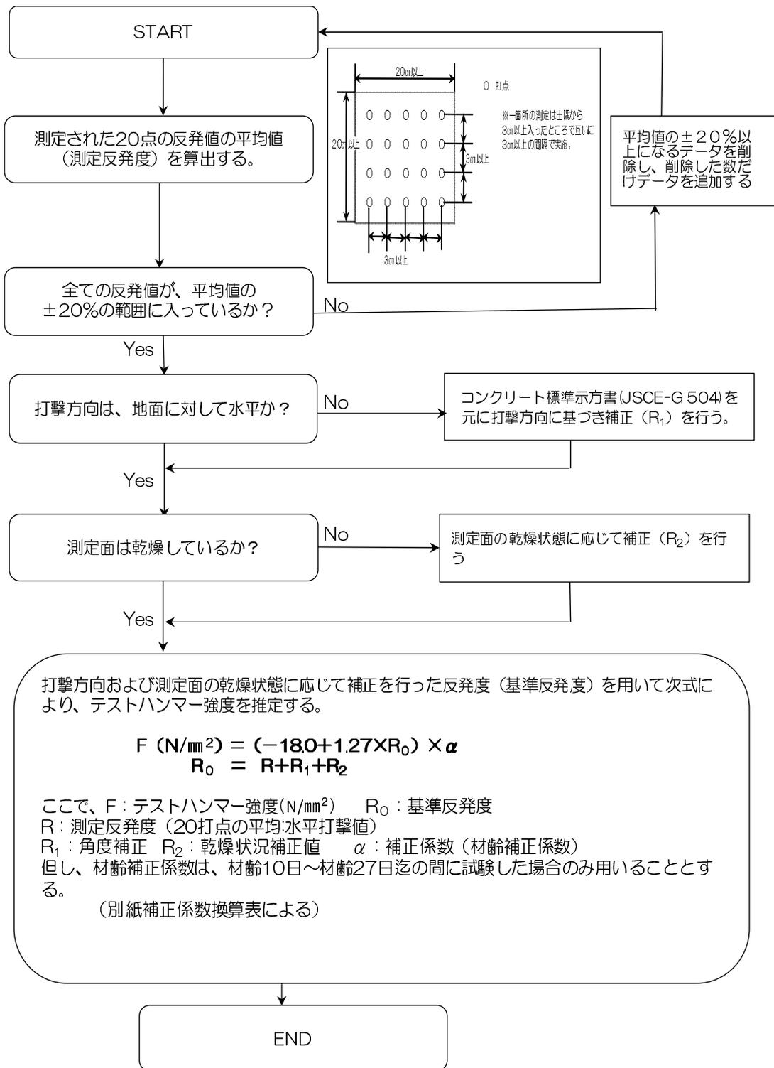
テストハンマー強度試験に係る補正值は、次の i) ~ iii) のとおりである。
