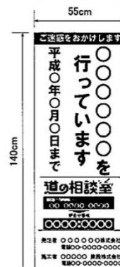
(様式4) 工事説明看板 (占用企業工事)
