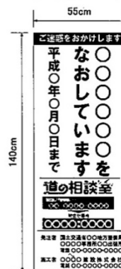
(様式2) 工事説明看板 (道路補修工事)
