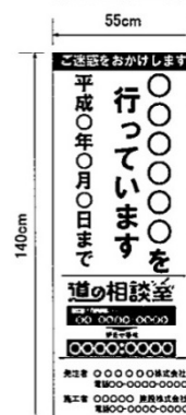
(様式4) 工事説明看板 (占用企業工事)
