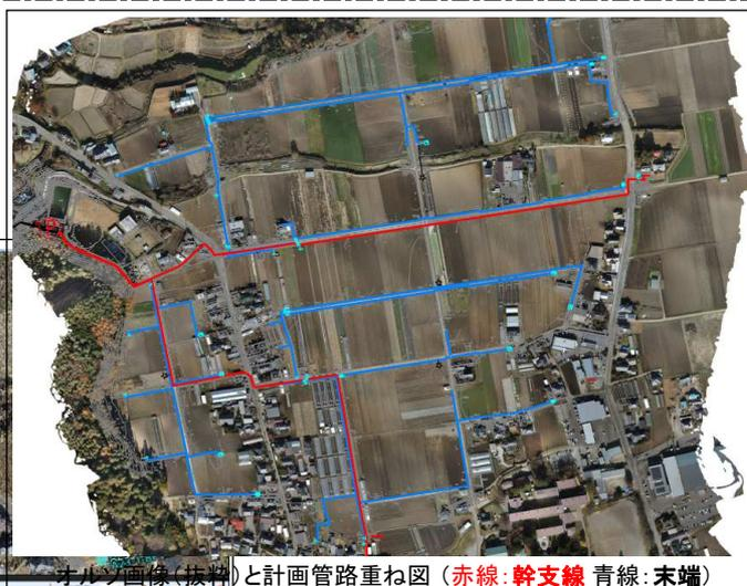
オルソ画像(抜粋)と計画管路重ね図 (赤線:幹支線 青線:末端)
