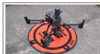
航空写真撮影に用いたUAV機体
