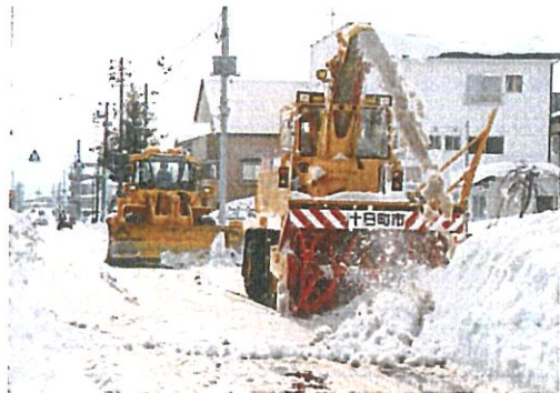
写真-3 除雪機械による作業風景
