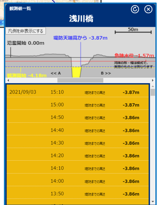
「浅川橋」における河川監視カメラと危機管理型水位計の表示例
